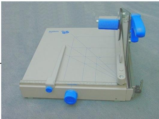
Das Gerät besteht im wesentlichen aus der Blechkonstruktion, dem Schneidhebel, dem Niederhalter mit Anpressleiste, sowie den auswechselbaren Distanzstücken. An der Querseite ist eine Anschlagleiste montiert. Die Distanzstücke sind parallel zum Untermesser angeordnet. Durch Auswechslung der Distanzstücke (Schnittbreite nach Kundenwunsch) Können verschiedene Schnittbreiten eingestellt werden.
