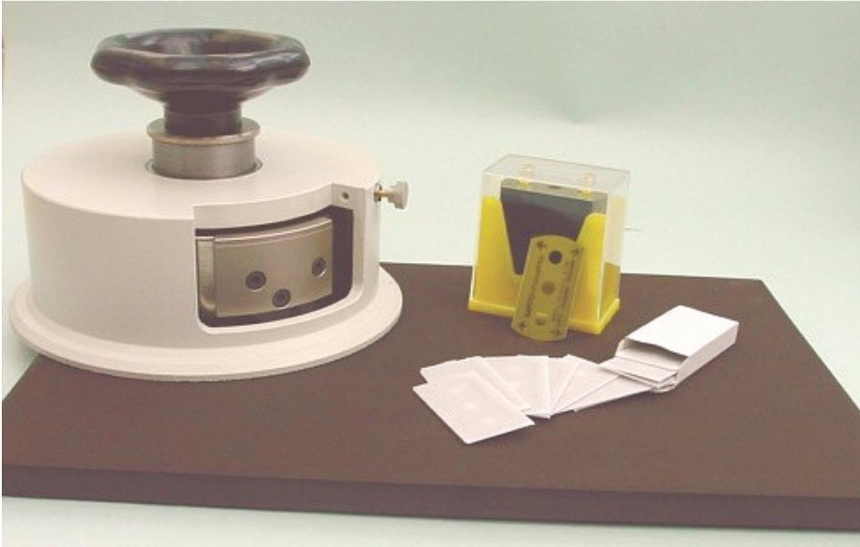
Durch vier Schneidmesser erhält man bei einer 1/4 Drehung bereits 1 Kreisblatt von 100 cm<sup>2</sup> Fläche (112,8mm Durchmesser). Diese Rundproben werden auf eine Waage gelegt, und man erhält so relativ schnell das Gesamtgewicht cm<sup>2</sup> des Papierses.
