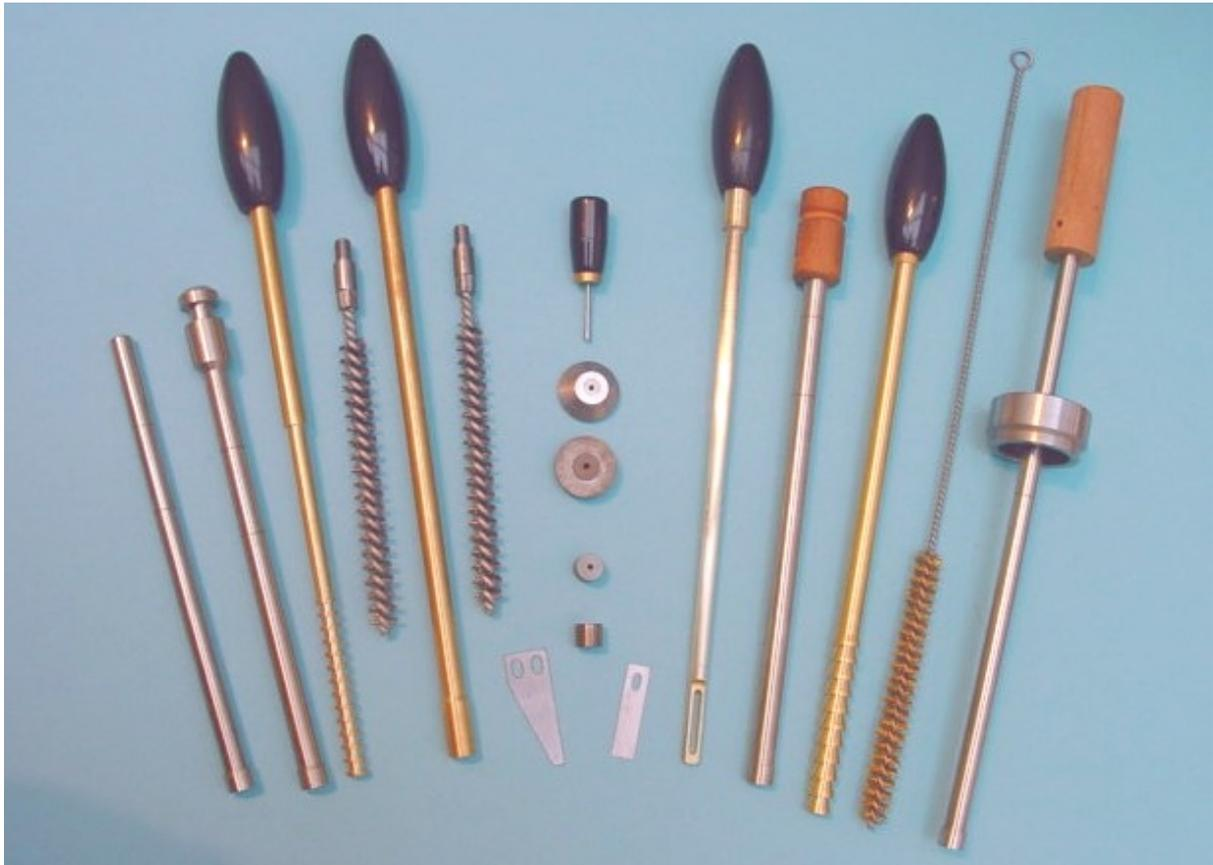
Druckstempel 9,48mm- Stahlbürsten für Prüfkanal- Reinigungskolben für Prüfkanal-
